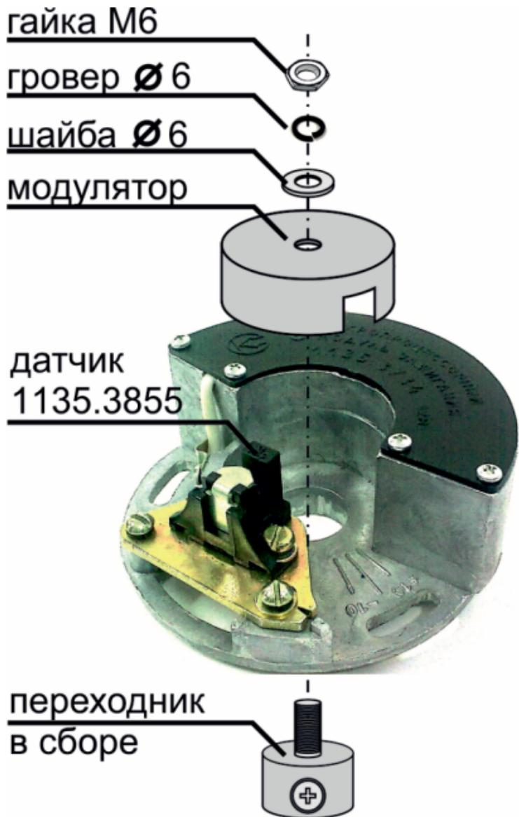
Рис.1. Схема установки МПБСЗ на «К750»
